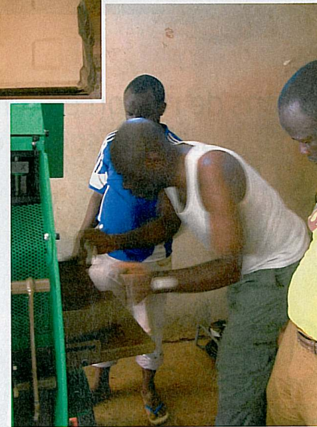
Ci-dessus, la brique en terre sèche conçue grâce à l'aide des étudiants de l'école polytechnique de Toulouse. Ci-contre, Jean-Hervé Mouélé fait fonctionner la machine qui lui permet de presser ses briques.
